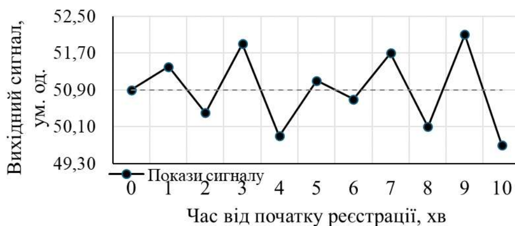
Рисунок 4.20 – Часова зміна сигналу B50 протягом 10 хв при T = 20\text{ }^{\circ}\text{C} , A = 1,0\text{ см}^2 і d = 3\text{ мм}
