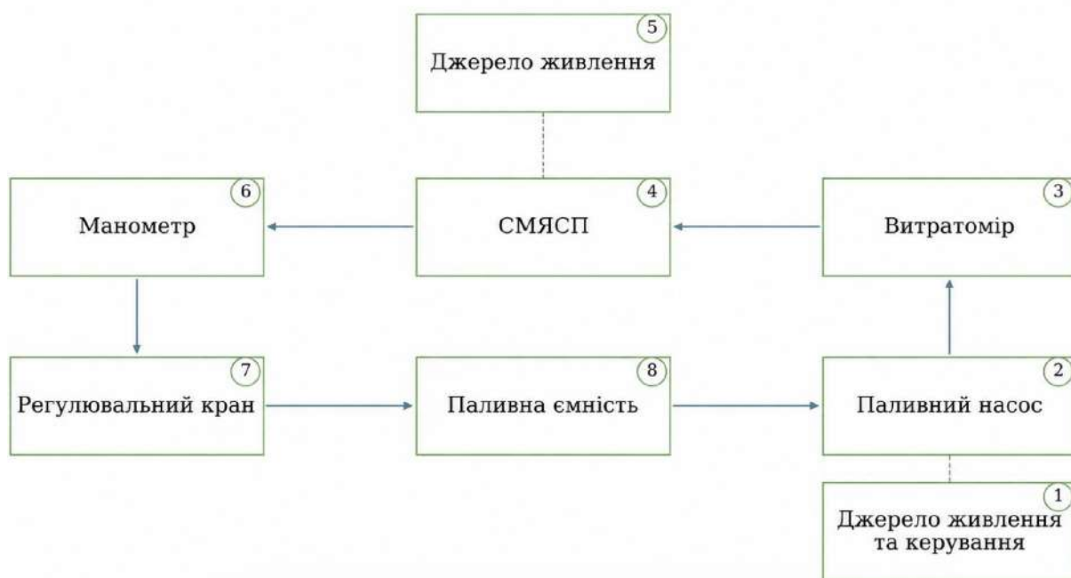
Рисунок 3.9 – Схема експериментального стенда: 1 – джерело живлення та керування; 2 – паливний насос; 3 – витратомір; 4 – СМЯСП; 5 – джерело живлення; 6 – манометр; 7 – регулювальний кран; 8 – паливна ємність.
