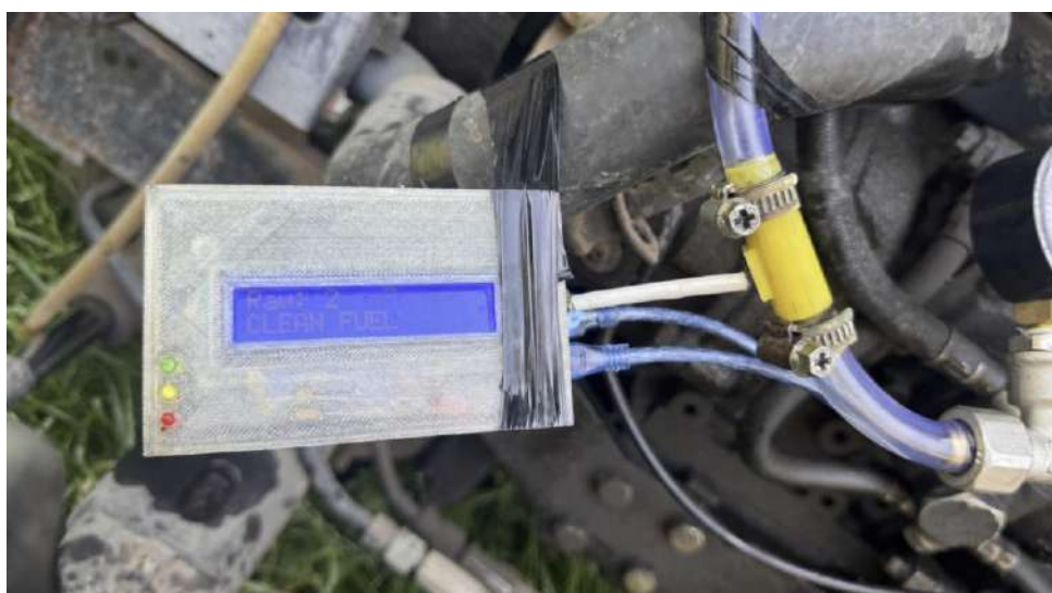
Рисунок 4.25 – СМЯСП на тракторі «Булат 244» з відображенням вихідного сигналу та стану індикації
