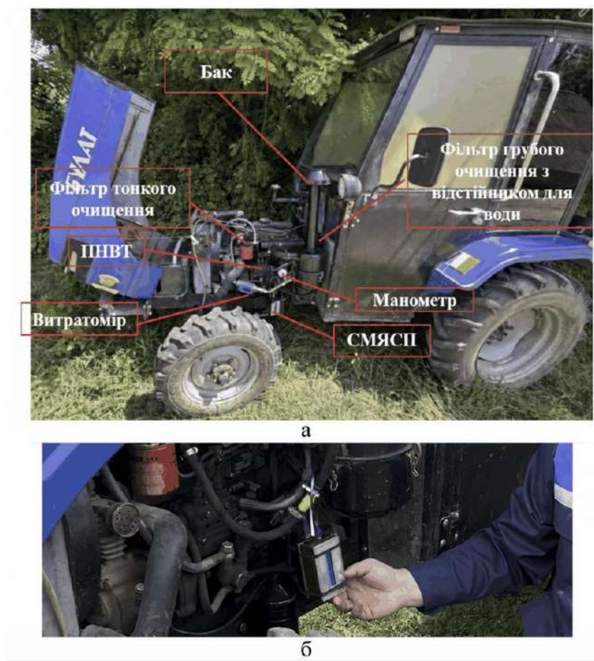
Рисунок 4.24 – Установлення СМЯСП у паливній системі мінітрактора «Булат 244»: а – загальний вигляд і розміщення обладнання; б – загальний вигляд підключеної СМЯСП.
