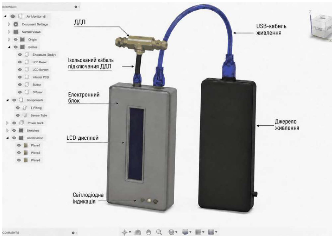
Рисунок 3.2 – Тривимірна модель СМЯСП із зовнішнім джерелом живлення
